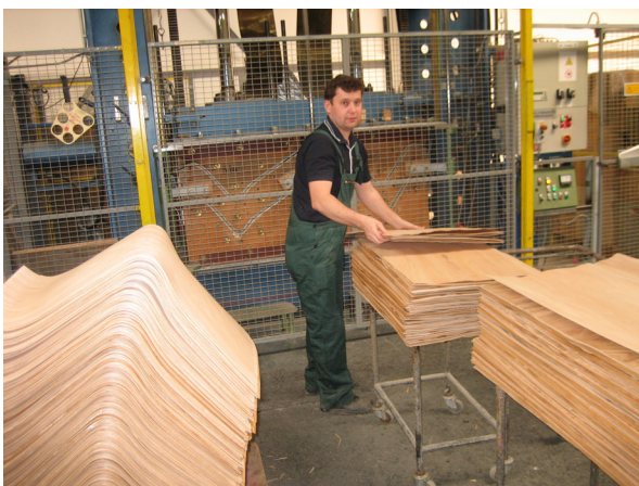
Bestückung der Presse mit vorbereitetem Buchenholz furnier
