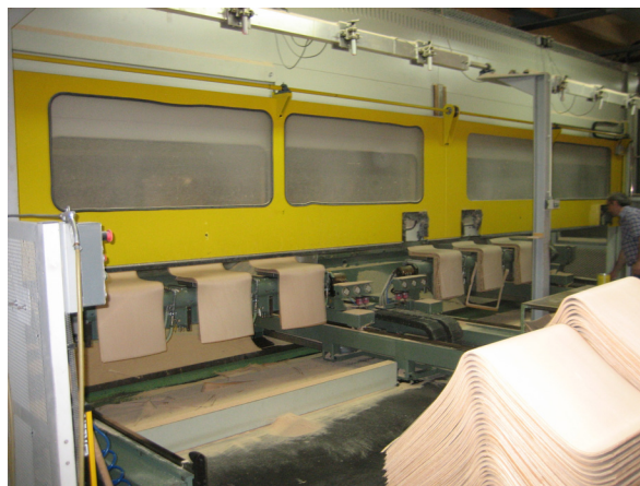
Automatische Fertigung der Sitzschalen
